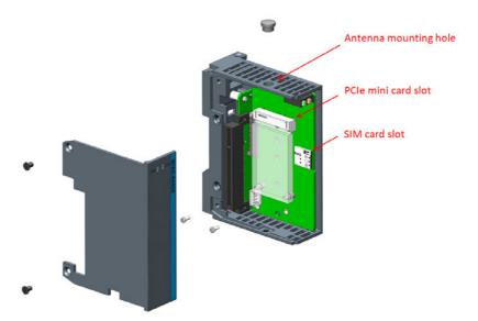
Figure 5.13 AMAX-5400E PCle mini card installation guide
